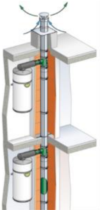
Chauffe-eau thermo monté sur conduit collectif
