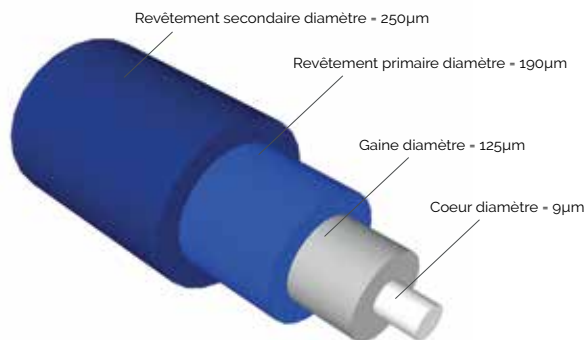
Fig. 75 | Structure d'une fibre optique (Rappel : 1 \mu\text{m} = 0,001 mm)
