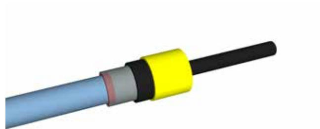
Fig. 99 | Connecteur type « gas block » (fait l'étanchéité entre le conduit et le câble par simple serrage de la bague jaune)
