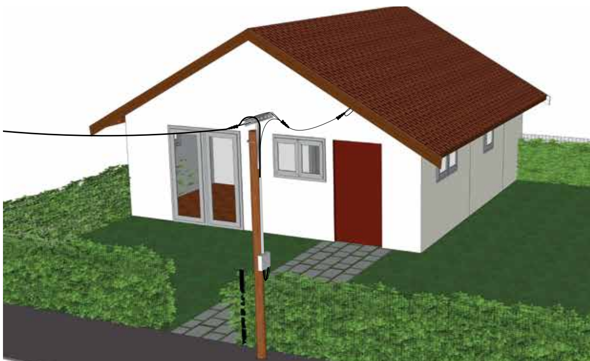
Fig. 28 | cas d'un branchement à partir d'un PBO sur poteau
