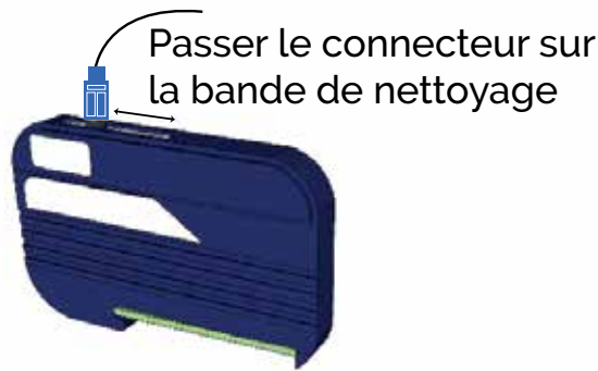
Fig. 82 | Cassette de nettoyage
