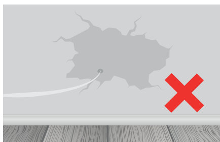
Fig. 18 | Cas d'un PBO et un parcours du câble en partie commune non conforme à l'étude initiale, avec percements non rebouchés
