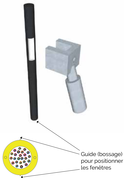
Fig. 91 | Ouverture de fenêtres dans les câbles de la colonne montante
