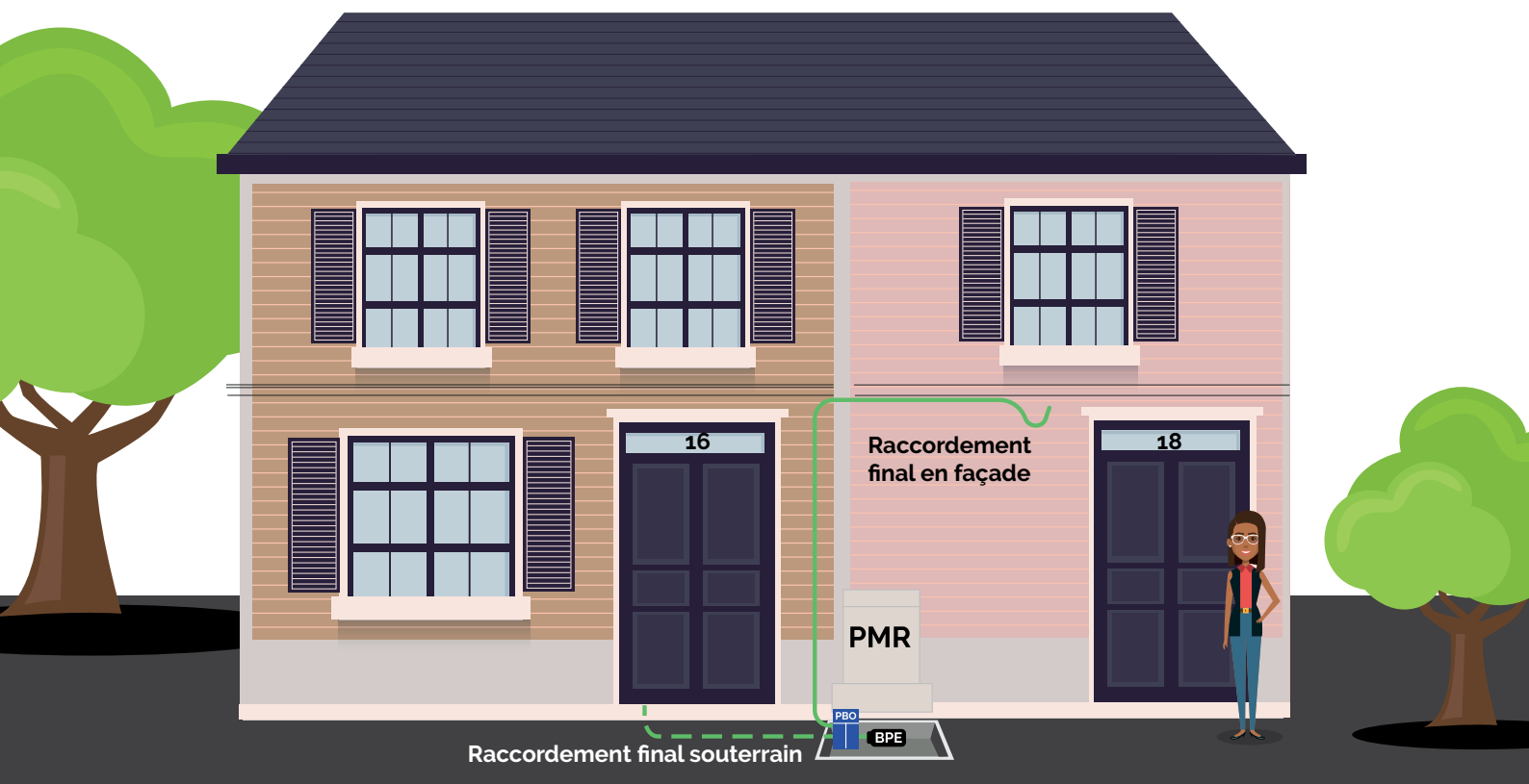
Fig. 03 | Cas de raccordement où toute la colonne de communication se trouve être sur la façade
