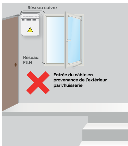
Fig. 22 | Cas d'une intervention chez le client avec parcours et percements ayant porté atteinte à l'esthétique du logement
