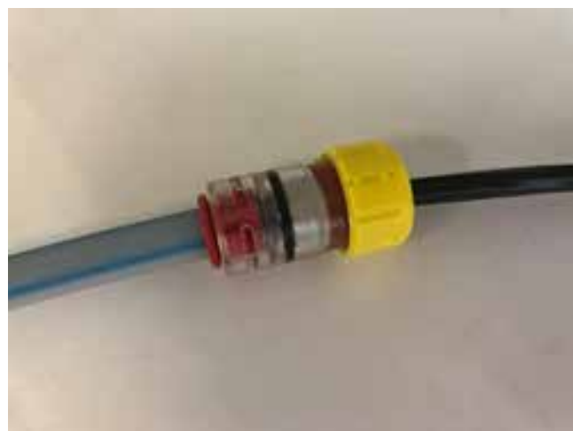
Fig 58 : Connecteur type « gas block » (fait l'étanchéité entre le conduit et le câble par simple serrage de la bague jaune)
